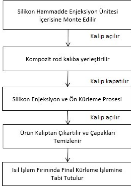
Şekil 2. Silikon izolatörün üretim akış şeması
