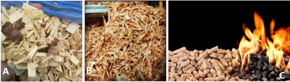
Şekil 3. Masif ahşap üretiminde ortaya çıkan küçük boyutlu artıklar (A: Cips, B: Talaş) ve Pelet (C) olarak kullanımı
