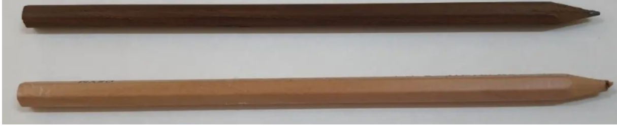
Şekil 8. Isıl işlemlenmiş (üst) ve işlemlenmemiş (alt) ahşaptan üretilen kalemler
