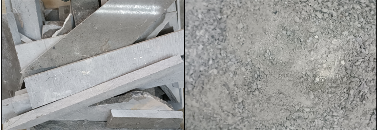
Şekil 2. Atık haldeki ve istenen boyutlara getirilmiş Zeytindalı taşı
