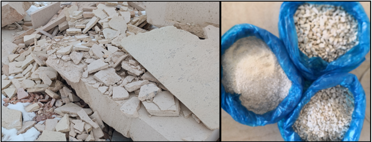
Şekil 1. Atık haldeki ve istenen boyutlara getirilmiş Bayburt taşı
